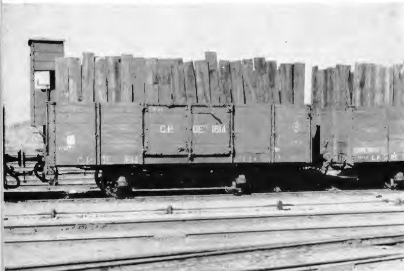
Abb. 7. Ein typisches Beispiel für eine „Kranzbildung“ entsprechend Heft 10/73, S. 664. Zur Sicherung und Erhöhung der Ladekapazität sind diese Bohlen an den Wagenwänden ringsum aufrecht gestellt (Aufnahme im Bf. Espinho/Portugal, 1000 mm-Schmalspur der CP).
