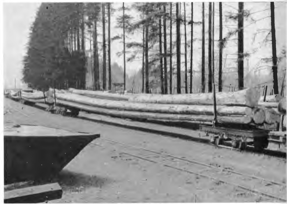
Abb. 9. u. 10. Langholztransport bei einer Vollbahn (oben, Bf. Eyach, Hohenzollern) und bei einer 760 mm-Waldbahn (Ošadnica-Zákamenné/CSSR). Während die Drehschemelwagen nach den Vollbahn-Vorschriften mittels einer Kupplungsdelchsel miteinander verbunden werden müssen, falls sie am Anfang oder inmitten eines Zuges laufen (s. a. MIBA 3/74, S. 132), ist dies bei den winzigen Drehschemel-Loren der nur als Zubringer fungierenden Waldbahn — auf Grund der völlig anders gearteten Betriebsverhältnisse — nicht vorgeschrieben bzw. nicht notwendig.
