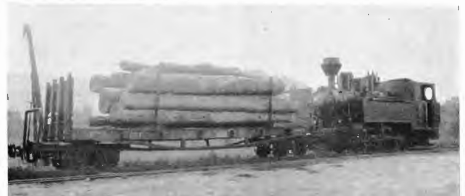
Abb. 16. Anscheinend nimmt man es auf rumänischen Waldbahnen (hier die 760 mm-Waldbahn Orastie) nicht so genau mit dem Sichern des Ladeguts durch Ketten o. ä. — oder dieser Rungenwagen ist noch nicht ordnungsgemäß abgefertigt! Interessant auch die Dampflok mit dem Funkenfänger-Kobelschornstein.
