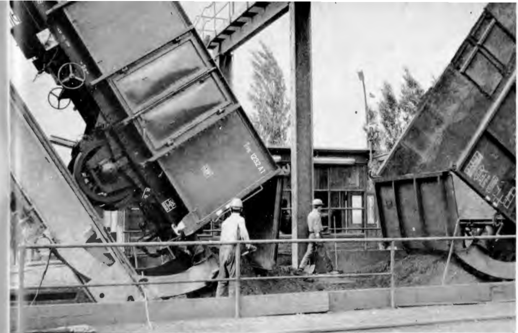
Abb. 5 zeigt links einen offenen Güterwagen mit durchgehendem Obergurt: das Winkelprofil, das den oberen Abschluß der Seitenwand bildet, ist deutlich erkennbar über die Türöffnungen hinweg durchgezogen. Bei dem rechten Wagen ohne durchgehenden Obergurt ist dagegen ebenso deutlich zu sehen, daß die Wagenwand auf ihrer ganzen Höhe durch die Tür unterbrochen wird. (Foto: OSTRA)
